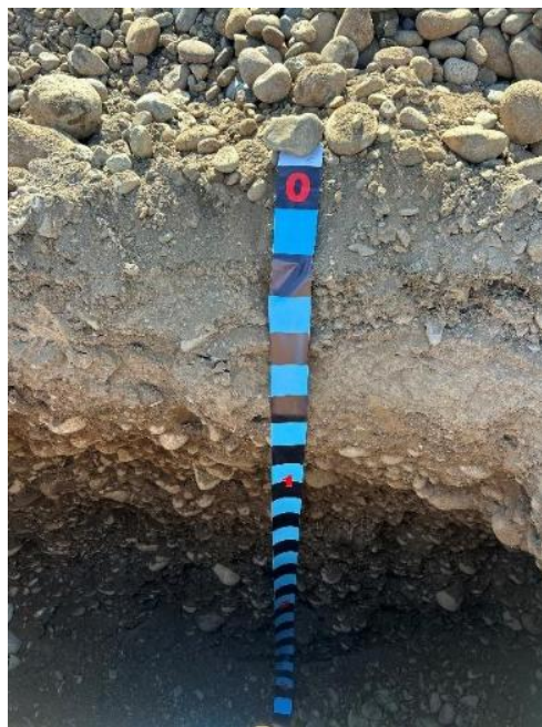
Pozo N°6 – Vista interior y estratos constituyentes
