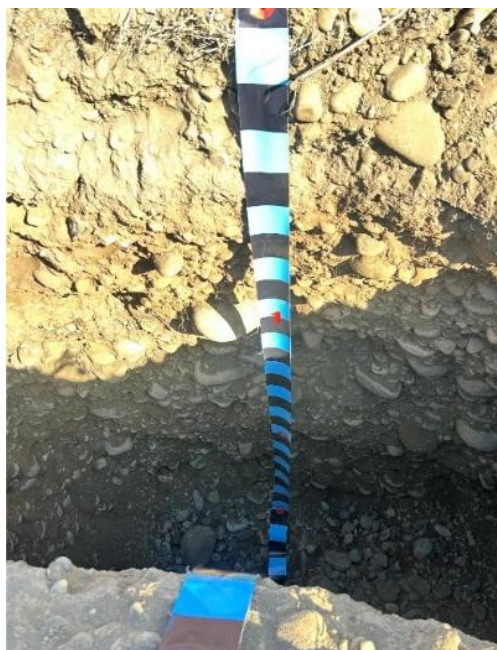
Pozo N°2 – Vista interior y estratos constituyentes
