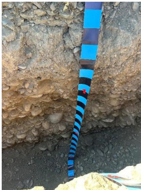
Pozo N°3 – Vista interior y estratos constituyentes.
