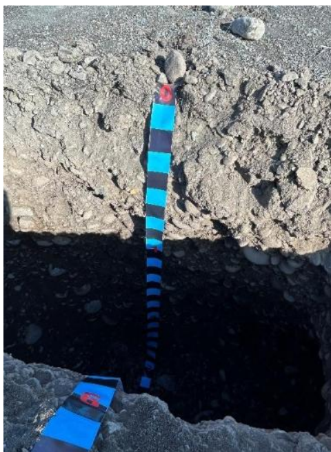
Pozo N°1 – Vista interior y estratos constituyentes
