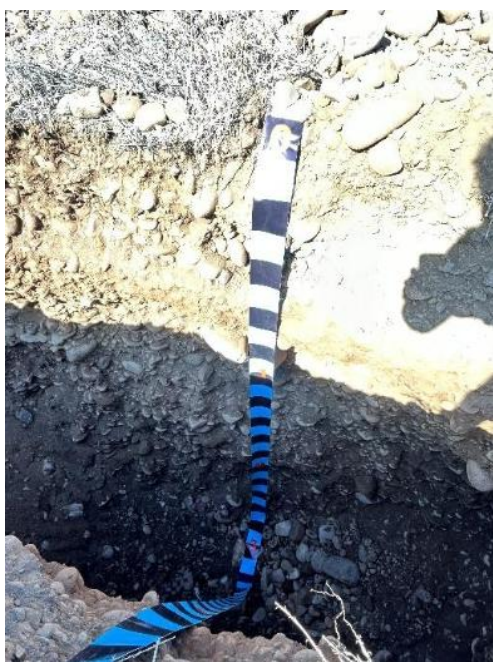
Pozo N°5 – Vista interior y estratos constituyentes
