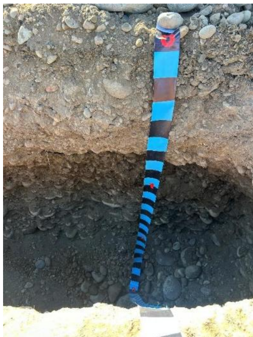
Pozo C – Vista interior y estratos constituyentes
